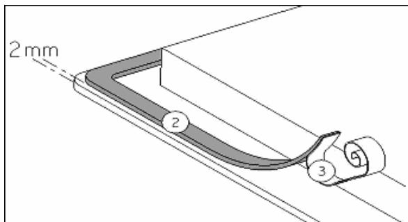
Die Dichtung (2) nach Abnehmen der Schutzfolie (3) mit 2 mm Abstand der Außer kannte des Glases aufkleben.
